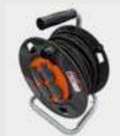
ENROULEUR ÉLECTRIQUE MOBILE IP44, 4 prises 16A avec claquet, 3G1.5mm², 25m, câble HO7RNF Réf. ENR-SOL25
