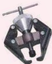
OUTIL DE DÉMONTAGE ESSUIE-GLACE frontaux montés avec vis et écrou. Après avoir dévissé la vis de fixation, positionner l'outil sur le bras d'essuie-glace et tendre uniformément jusqu'à ce que ce dernier se détache.
