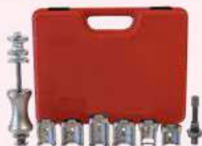
COFFRET MULTI-EXTRACTEURS D'ESSUIE-GLACE marteau tire-clou et guide d'utilisation inclus, pour différentes marques de véhicules. Accrocher un extracteur à la poignée, remonter le marteau tire-clou et appuyer vers l'avant. Si cela ne fonctionne pas, intervenir avec l'axe presseur.
