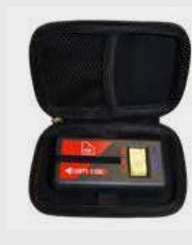
APPAREIL DE MESURE DE TEINTE DE VITRE permet de mesurer la transmission de lumière visible afin de savoir si l'utilisateur est en infraction ou non, suite à la nouvelle réglementation datant du 1 er janvier 2017. La transmission lumineuse doit être de minimum 70%.
