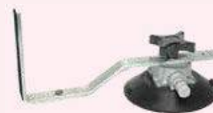
VENTOUSE D'AJUSTEMENT PARE-BRISE avec feutre de protection, positionner la ventouse à blanc, la butée doit être calée sur le capot, une fois le PB encollé il est automatiquement bien placé
