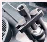
EXTRACTEUR D'ESSUIE-GLACE pour lunettes arrière VW, Audi, Skoda, Seat... Desserrer le bouton du bras sans le retirer (peut causer des dommages sur les plastiques) Placer les mâchoires sur le bras, serrer à la main puis avec un cliquet 3/8 pour tendre et libérer le balai. Lubrifier de temps en temps.
