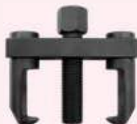
EXTRACTEUR D'ESSUIE-GLACE pour lunettes arrière VW, Audi, Skoda, Seat... Desserrer le bouton du bras sans le retirer (peut causer des dommages sur les plastiques) Placer les mâchoires sur le bras, serrer à la main puis avec un cliquet 3/8 pour tendre et libérer le balai. Lubrifier de temps en temps.
