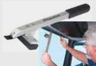
OUTIL DÉMONTE JOINT FOOTLOSE pour les joints de pare-brise larges, insérer l'embout entre la vitre et la baie et appuyer légèrement vers l'extérieur afin de retirer le joint
