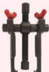
EXTRACTEUR D'ESSUIE-GLACE UNIVERSEL avec bras ajustables, verrouillables et interchangeables. Ajuster les bras jusqu'au bord des balais, utiliser un cliquet pour tendre le boulon.
